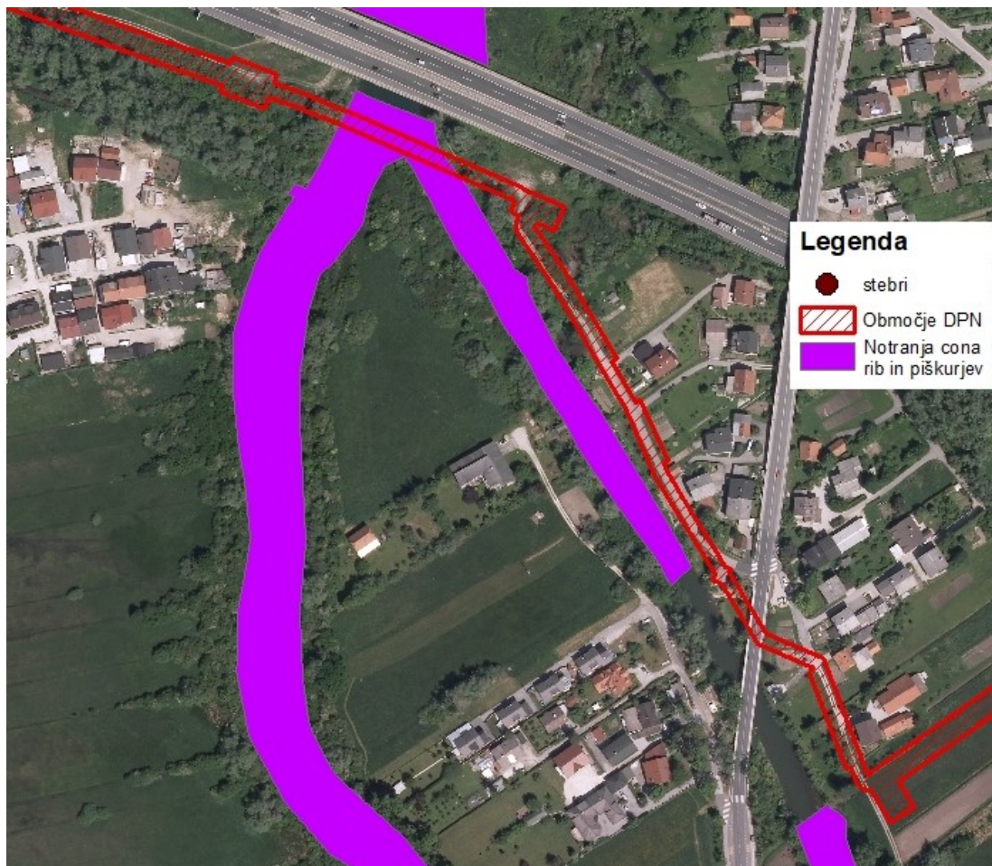
Slika 12: Prikaz trase podzemnega voda in podvrtavanja ter notranjih con rib in piškurjev
