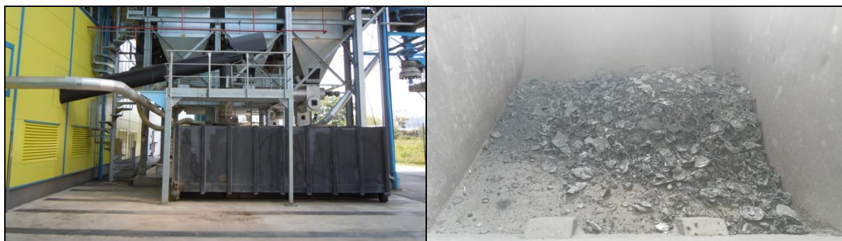
Slika 79: Zaprti kontejner za ogorki in žlindra ter kontejner z izločenimi kovinskimi delci [vir: EIMV]
