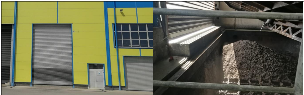
Slika 77: Sprejemnica za blato iz čistilnih naprav komunalnih odpadnih vod [vir: EIMV]
