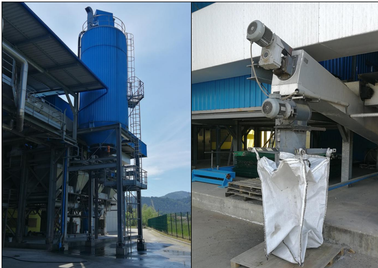
Slika 78: Namenski silos (nevarnega) pepela, ki omogoča neposredno praznjenje v cisterno transportnega vozila (levo) in big-bag vreča s procesnim aktivnim ogljem (desno) [vir: EIMV]
