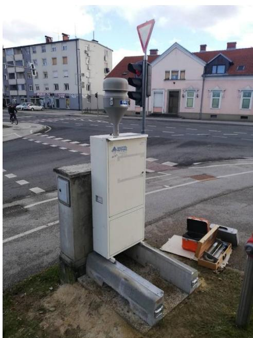
Slika 1. Gravimetrični vzorčevalnik delcev PM<sub>10</sub> v
