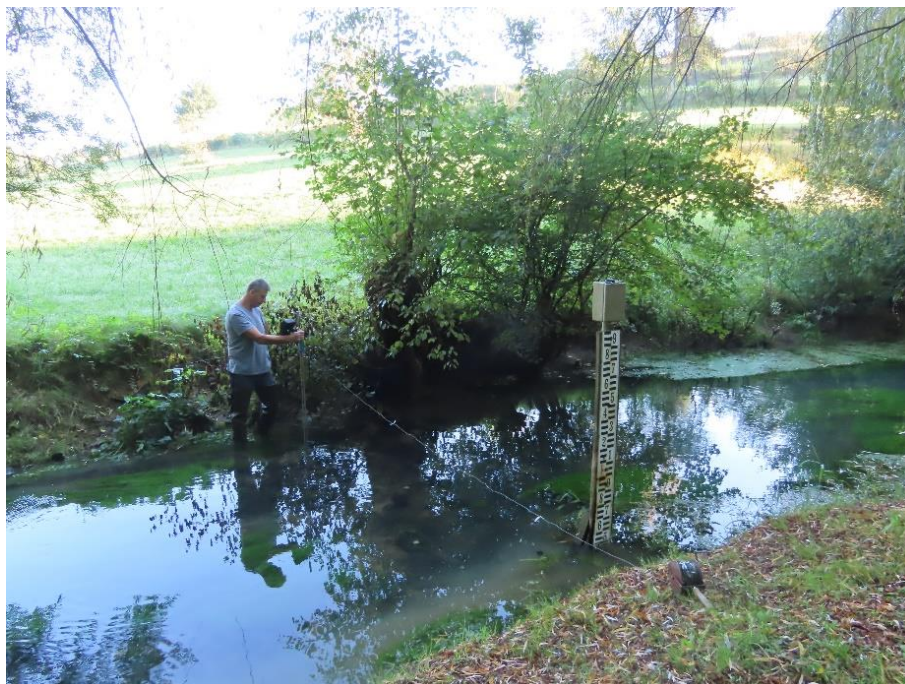
Slika 2. Meritve pretoka izvira Težke vode v Stopičah avgusta, 2020 (Foto: arhiv ARSO) Figure 2. Discharge measurement of Težka voda spring in Stopiče, August 2020 (Photo: ARSO archive)
