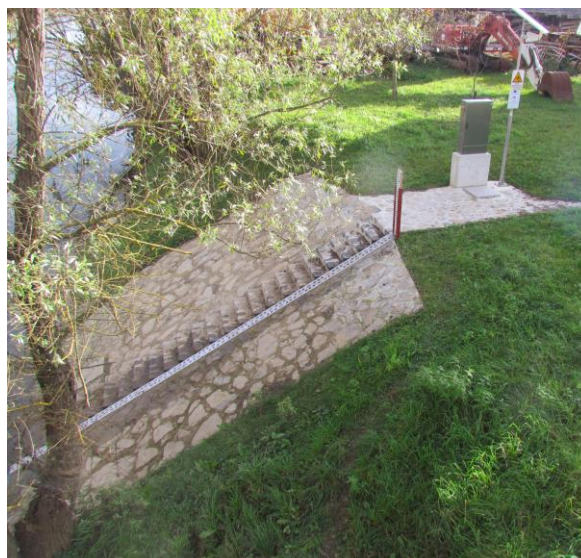
Slika 2. Hidrološka postaja Krka Gorenja Gomila. Merilno mesto je opremljeno z vodomerno letvijo, avtomatskim tlačno-temperaturnim senzorjem za izvajanje meritev pretoka in temperature vode (foto: arhiv ARSO). Figure 2. Gauging station Krka Gorenja Gomila (Photo: ARSO archive)
