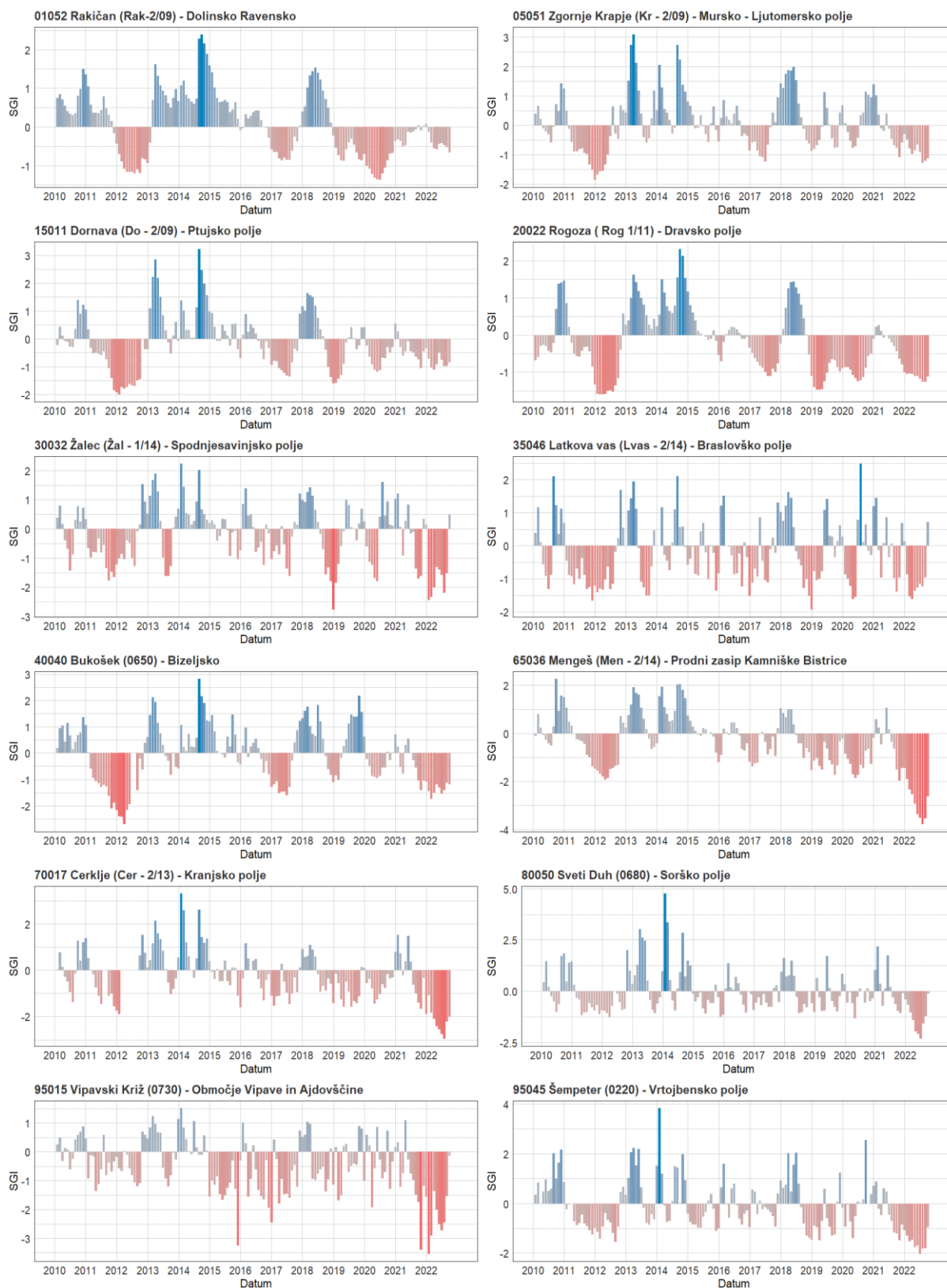
Slika 4. Potek standardiziranega indeksa povprečnih mesečnih gladin podzemne vode (SGI) od leta 2010 na izbranih merilnih mestih. Več na povezavi: http://www.meteo.si/met/sl/watercycle/diagrams/sgi/ Figure 4. Standardized mean monthly groundwater level values (SGI) from 2010 on selected measuring locations. More information is available on http://www.meteo.si/met/sl/watercycle/diagrams/sgi/
