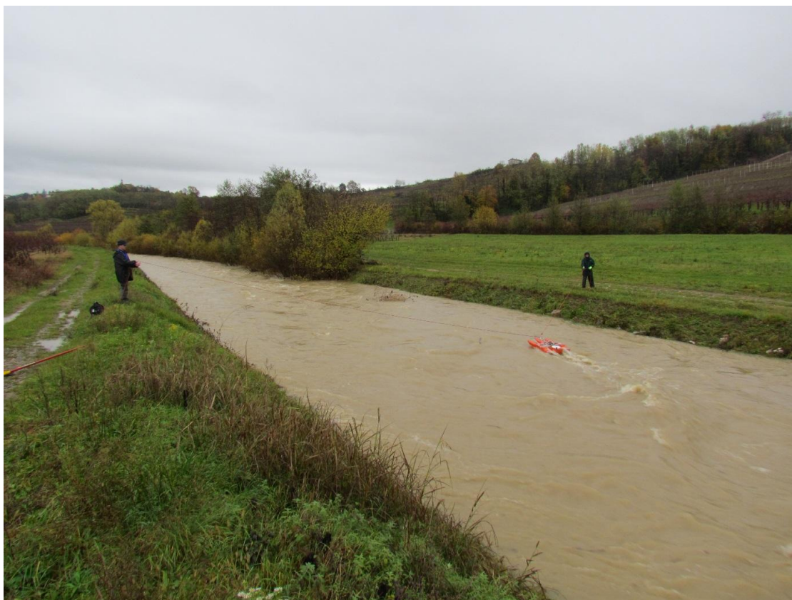
Slika 2: Meritev pretoka visoke vode v Neblem na Reki 17. novembra 2016 z ADCP merilnikom (foto: Primož Gajser)
