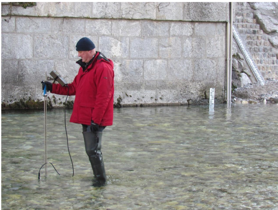
Slika 3: Meritev pretoka Tolminke v Tolminu pri nizkem vodnem stanju 21. decembra 2016 s FT merilnikom (foto: arhiv ARSO)
