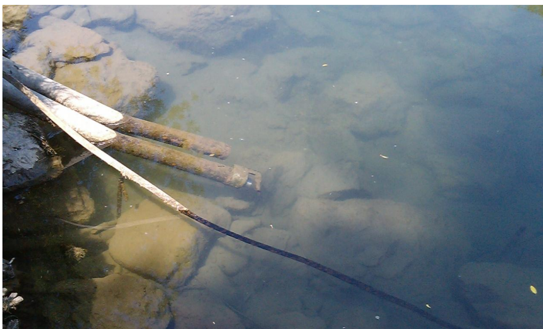
Slika 9: Primer namestitve merilnika motnosti v cevi na vodomerni postaji Suha na Sori (foto: arhiv ARSO)
