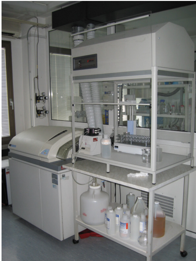
Induktivno sklopljena plazma z masno selektivnim detektorjem (foto: Gregor Muri)
