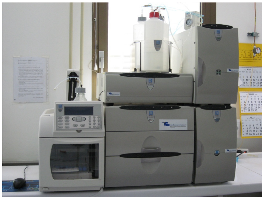
Ionski kromatograf, s katerim določamo levoglukozan in ostale sladkorje v delcih (foto: Gregor Muri)
