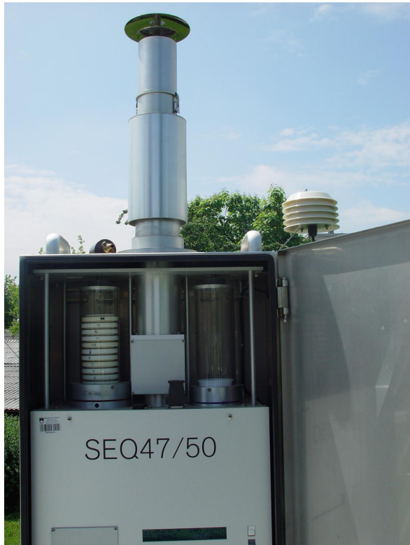
Referenčni merilnik Leckel, s katerim spremljamo meritve delcev PM_{10} in PM_{2.5} (foto: Tanja Bolte)
