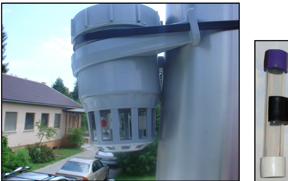
Ohišje difuzivnega vzorčevalnika (levo) in difuzivni vzorčevalnik za anorganske spojine (desno) (foto: Tanja Koleša)
