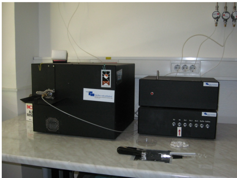
Analizator za organski in elementarni ogljik (foto: Gregor Muri)
