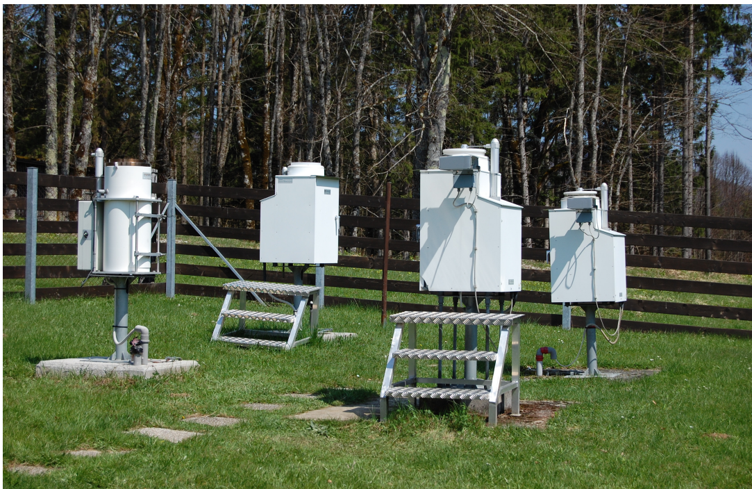
Vzorčevalniki za padavine Eigenbrodt na Iskrbi pri Kočevski reki (foto Marijana Murovec)
