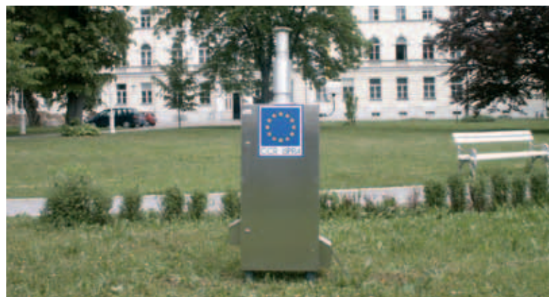
Referenčni merilnik Leckel, s katerim spremljamo meritve delcev PM 10 in PM 2,5 (foto: Peter Pavli)
