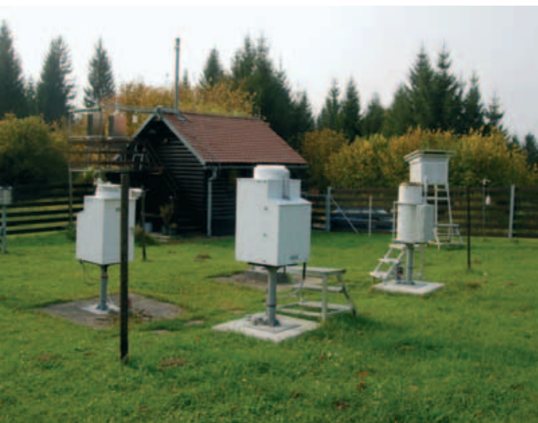
Vzorčevalniki za padavine na Iskrbi pri Kočevski Reki (foto: Peter Pavli).
