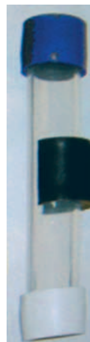
Ohišje difuzivnega vzorčevalnika (levo), difuzivni vzorčevalnik za organske spojine (na sredini), difuzivni vzorčevalnik za anorganske spojine (desno) (foto: Tanja Koleša)
