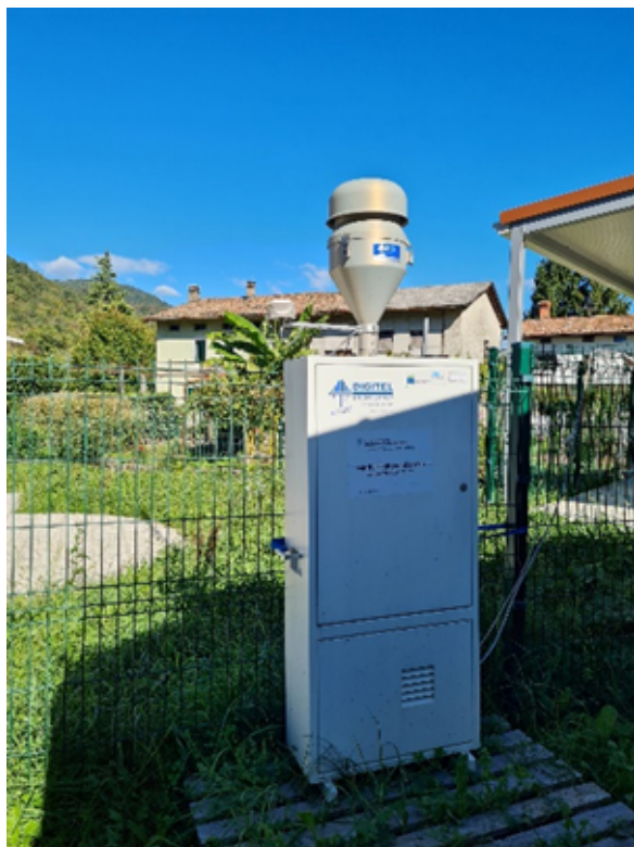
Slika 29: Visokovolumski vzorčevalnik Digitel za delce PM 10 pri Vrtcu v Desklah.
