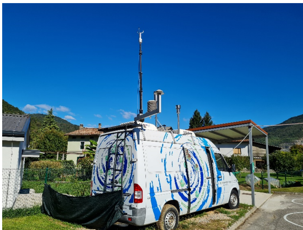
Slika 1: Kombi za meritve kakovosti zunanjega zraka in meteoroloških parametrov na lokaciji pri vrtcu v Desklah.
