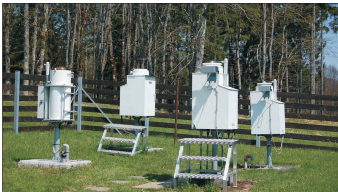
Padavinski vzorčevalniki na merilnem mestu Iskrba pri Kočevski Reki (foto: Marijana Murovec)
