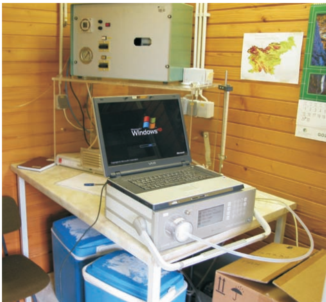
Merilnik živega srebra Mercury Ultratracer UT-3000, izpostavljen na merilni postaji Iskrba s prenosnim računalnikom za odčitavanje izmerjenih podatkov (foto: Tanja Koleša)
