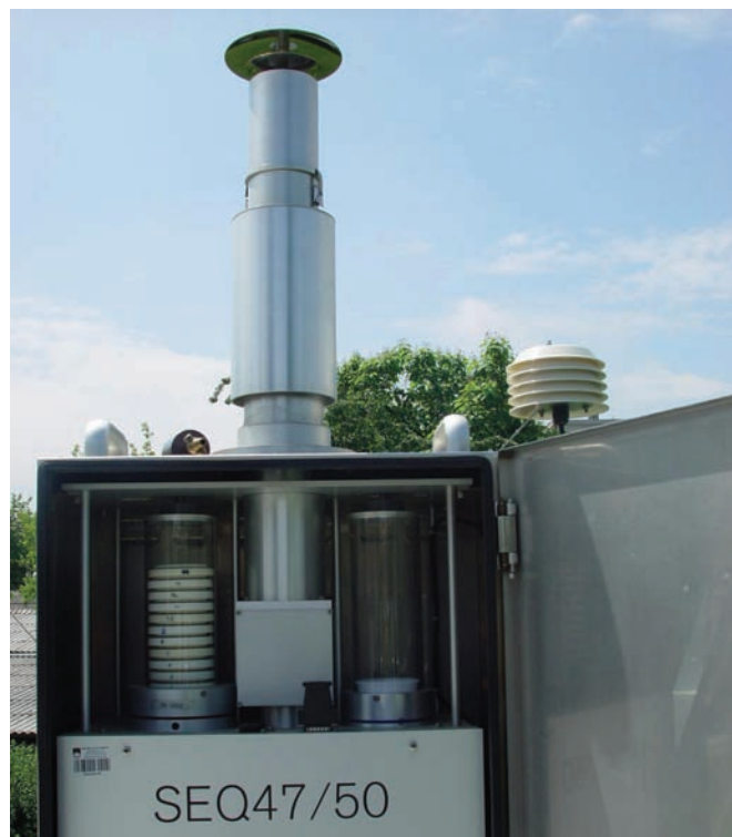
Referenčni merilnik Leckel, s katerim spremljamo meritve delcev \text{PM}_{10} in \text{PM}_{2.5} (foto: Tanja Bolte)
