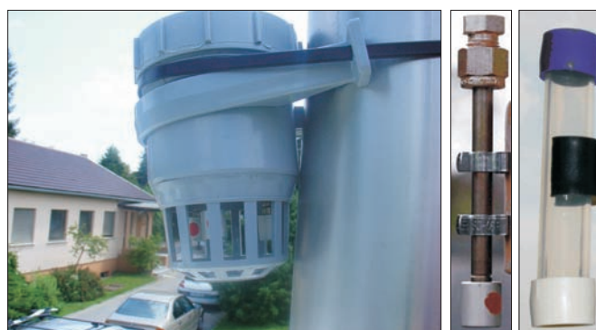
Ohišje difuzivnega vzorčevalnika (levo), difuzivni vzorčevalnik za organske spojine (na sredini), difuzivni vzorčevalnik za anorganske spojine (desno) (foto: Tanja Koleša)
