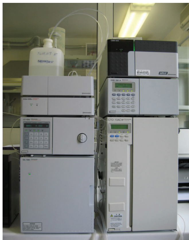
Ionski kromatograf (foto: Gregor Muri)
